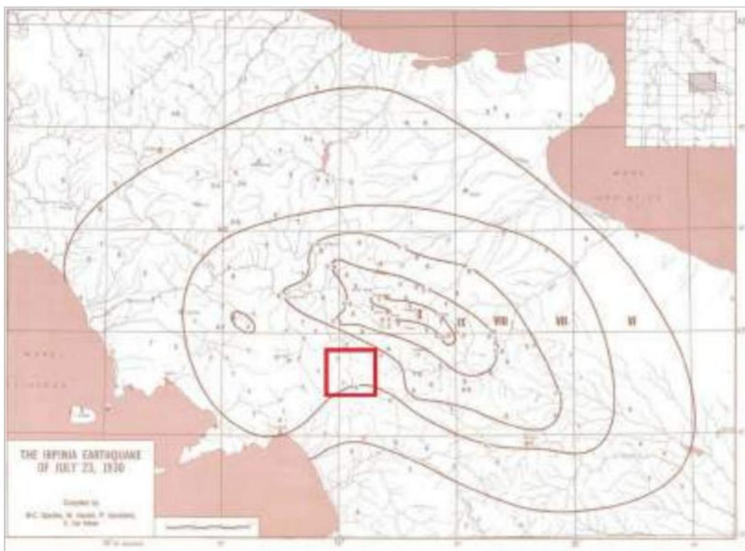
**Figura 31:** Linee isosisme del terremoto del 23 luglio 1930 (Spadea et al., 1985).
