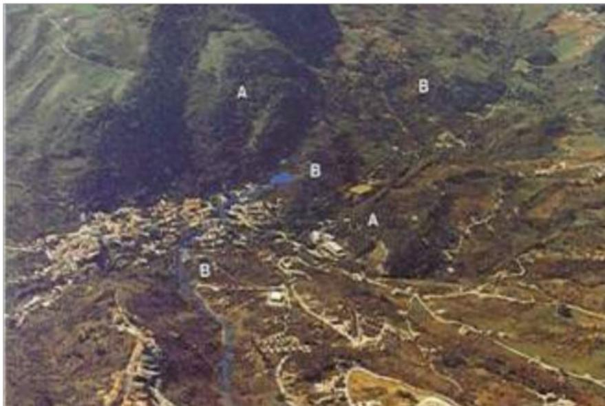
**Figura 23:** La sorgente Sanità di Caposele nel suo ambito geografico e idrogeologico: A = acquifero carbonatico; B = terreni impermeabili relativi (Cotecchia et al., 1993; integrato Civita, 2005).
